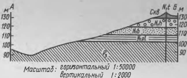
Рис. 27. Геологическая карта и геологический разрез района, сложенного горизонтально залегающими породами
