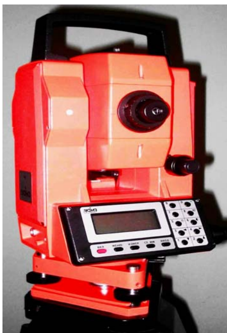
Рис. 23. Вид электронного теодолита-тахеометра 3Та5Р
