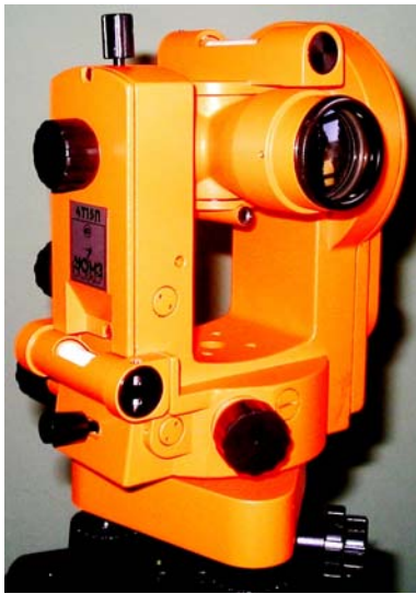
Рис. 15. Вид оптического технического теодолита 4Т15П
