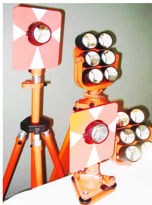
Рис. 24. Вид комплекта призмных отражателей
