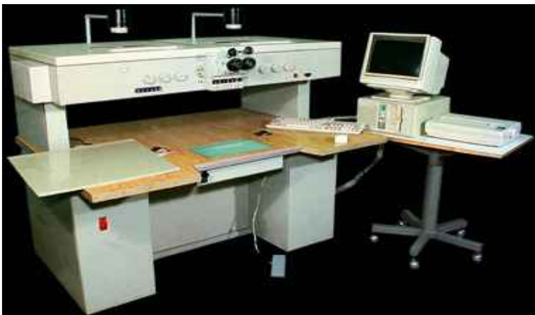
Рис. 95. Общий вид автоматизированного стереофотограмметрического комплекса АСФК
