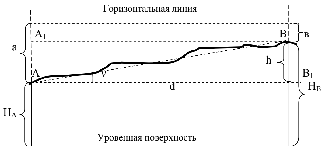
Рис. 5. Схема определения высотного положения точек местности
