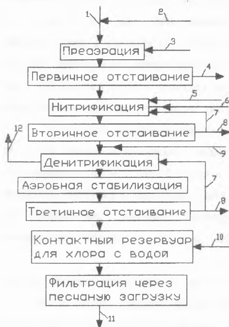
Рис. 34. Схема сооружений доочистки городских сточных вод в районе залива г. Сан-Франциско (США):
