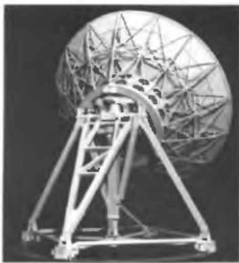
Рис.1.94. 16-метровый отечественный радиотелескоп нового поколения типа РТФ в исполнении РТФ-16-С с ограниченным сектором наведения и разделением приводов на следящие и переустановочные, с самоподъемом конструкции в заданное положение:
