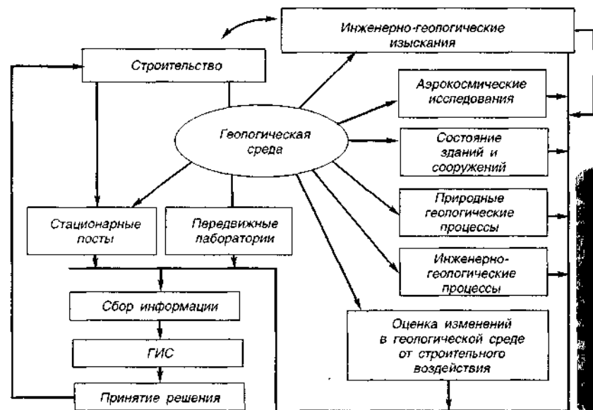
Р и с . 166. Функциональная схема геoinформационной системы оценки влияния строительства на геологическую среду
