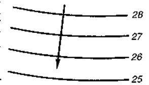
Рис. 50. Определение направления потока воды по карте гидроизогипс
