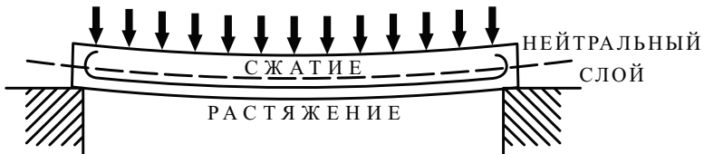
Рис. 9. Работа железобетона под изгибающей нагрузкой
