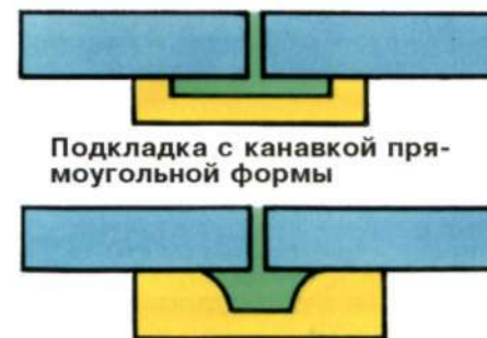
Подкладка с канавкой квадратного сечения с закругленными кромками
