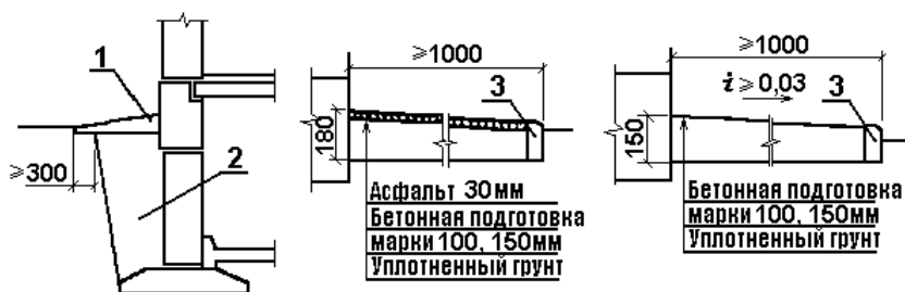
Рис. 66. Устройство отмостки.
