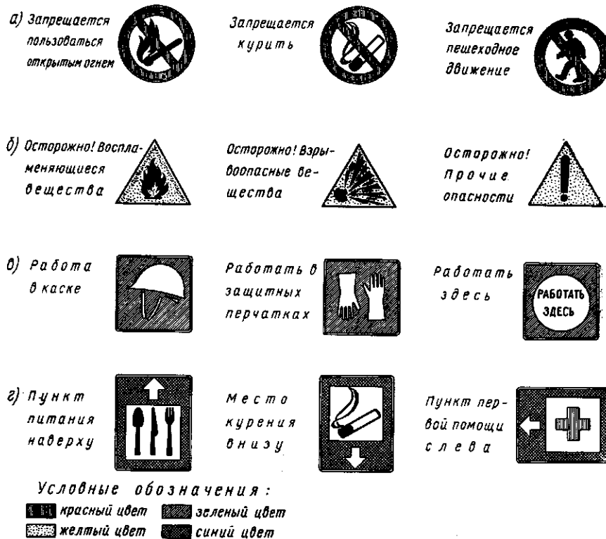
Рис. VIII-9. Примеры производственных знаков безопасности: а — запрещающие; б — предупреждающие; в — предписывающие; г — указатели
