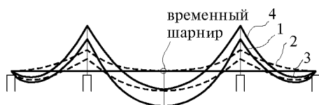
Рис.13.33. Эпюры изгибающих моментов в неразрезной балке
