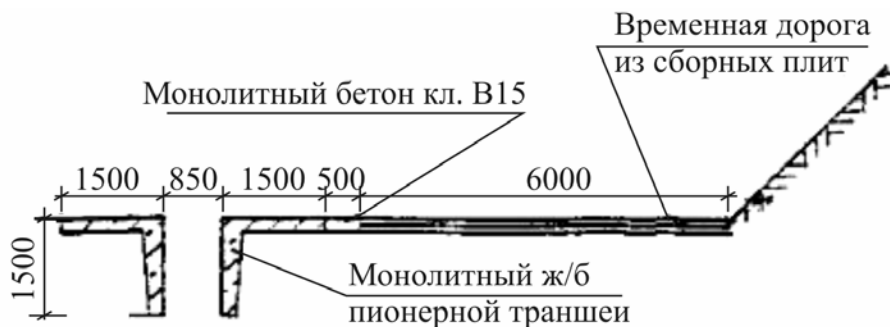
Рис. 2.25. Сопряжение воротника форшахты с временной дорогой [12]
