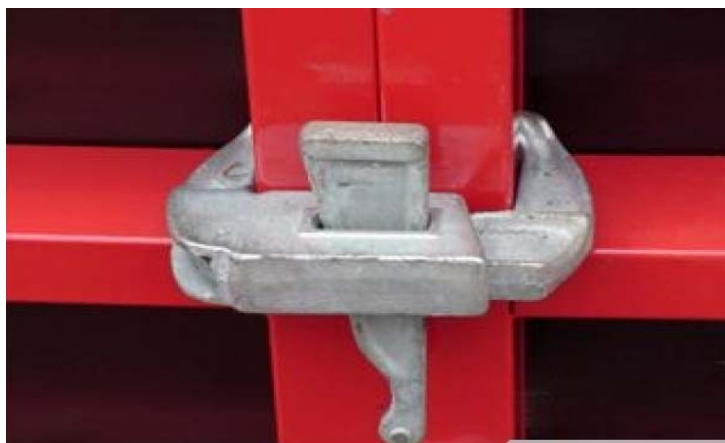
Рис. 2.40. Клиновой замок опалубочной системы MEVA
