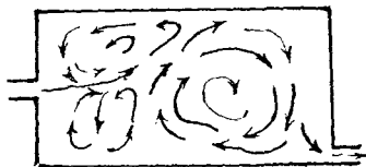
Рис. VI—12. Налипание струи на стенку с приточным отверстием в середине модели
