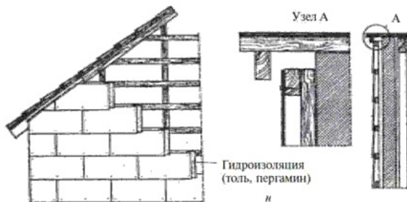
Рис. 141 (продолжение). Крепление крупноразмерных листов на фасаде здания: и – облицовка фасада здания у крыши
