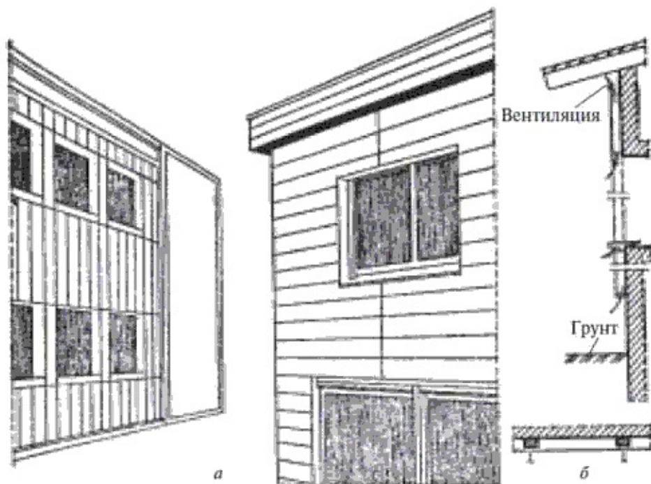
Рис. 139. Облицовка наружных стен крупноразмерными плитами: а – вертикально и горизонтально уложенные плиты; б – вертикальный разрез облицовки
