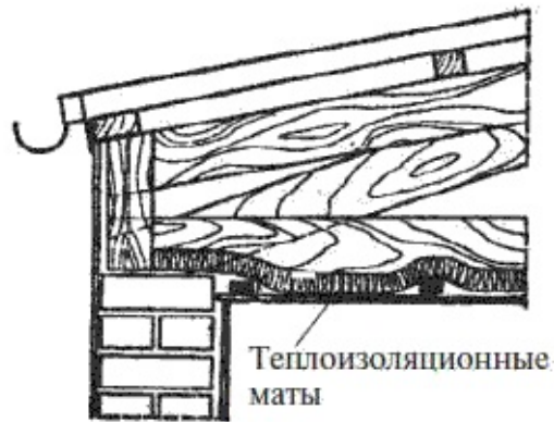
Рис. 148. Теплоизоляционные маты над чердачным перекрытием
