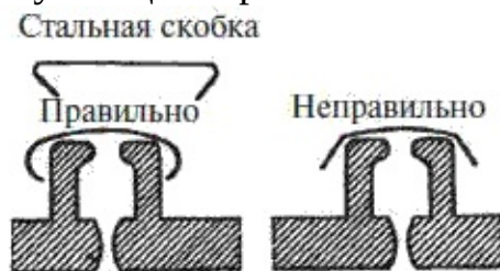
Рис. 102. Стальные скобы для стягивания изразцов
