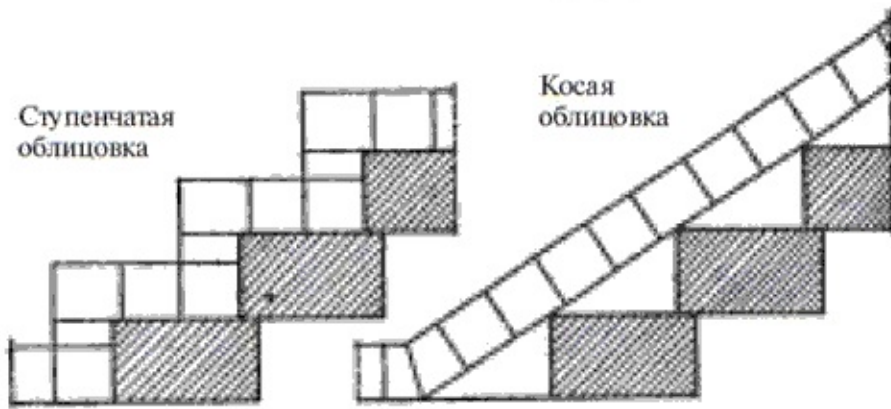
Рис. 158. Облицовка лестничного цоколя плитками
