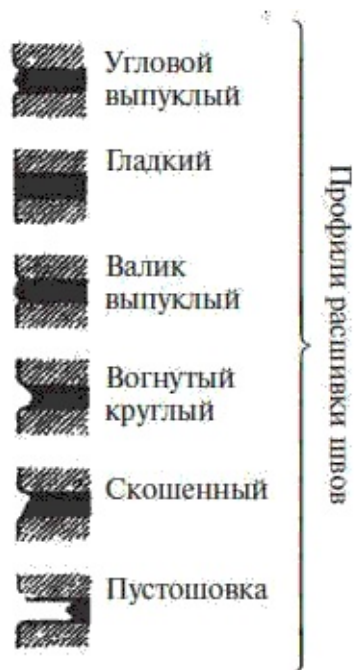
Рис. 2. Профилировка швов кирпичной кладки
