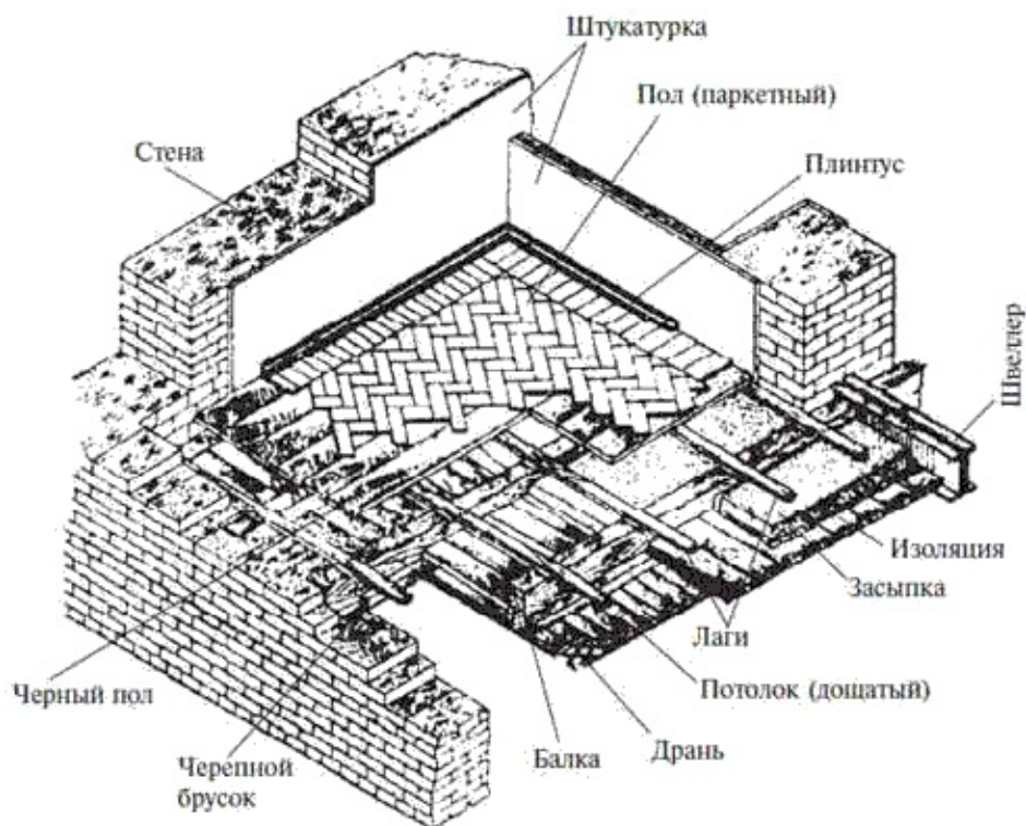
Рис. 3. Устройство междуэтажного перекрытия
