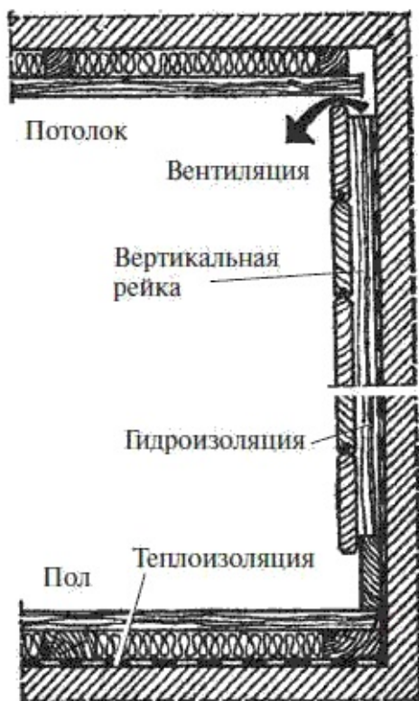
Рис. 114. Горизонтальная облицовка с тепло- и гидроизоляцией
