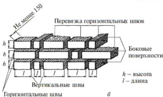
Рис. 130. Бутовая кладка, используемая для облицовок: а, б – из блоков правильной формы; в – из грубо обработанных камней
