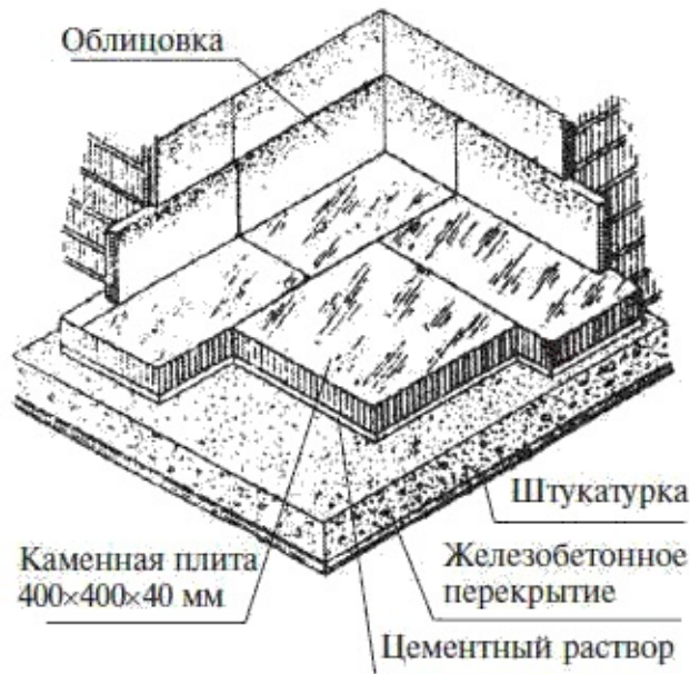
Рис. 12. Пол из естественных камней
