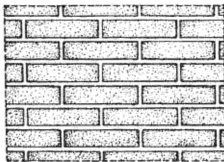
Рис. 101. Общий вид облицовки фасадными керамическими плитками
