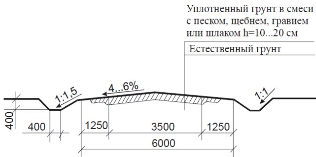
Рис. 6.1. Профиль временной дороги с улучшенным покрытием
