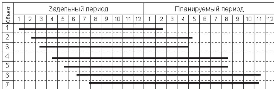
Рис. 1.5. Календарный план строительства при излишнем заделе
