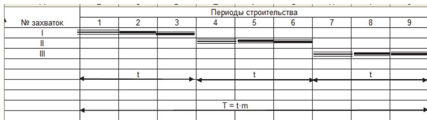
Рис. 1.6. График строительства объектов последовательным методом
