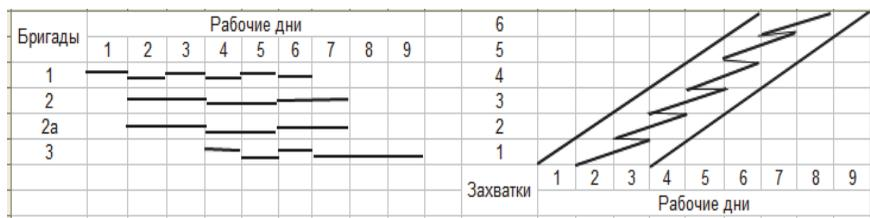
Рис. 1.13. Линейный график и циклограмма при кратноритмичном потоке
