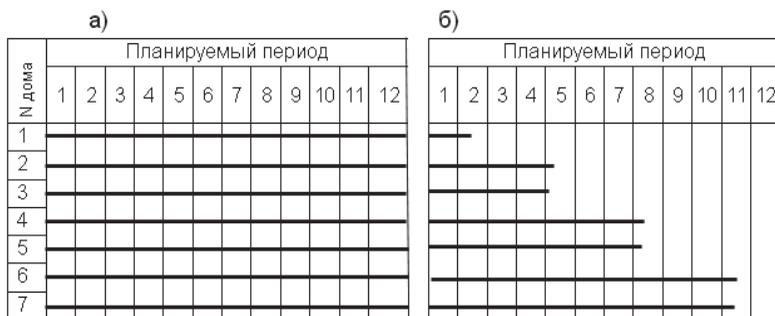
Рис. 1.4. Календарный план строительства при отсутствии задела:
