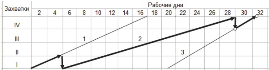
Рис. 1.20. Циклограмма разноритмичного потока без совмещения процессов с первым вариантом без разрывного пути
