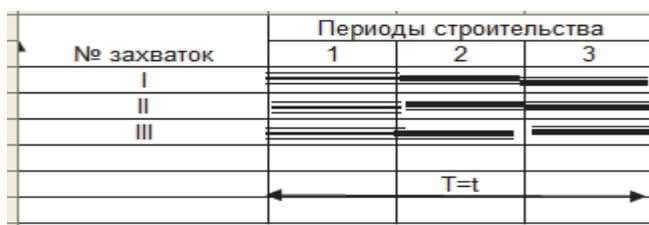
Рис. 1.7. График строительства объектов параллельным методом
