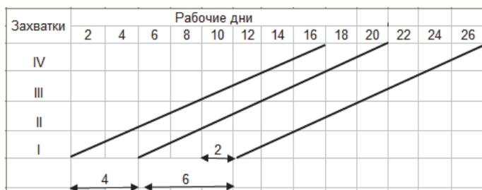
Рис. 1.17. Циклограмма равноритмичного потока без совмещения работ с технологическим перерывом
