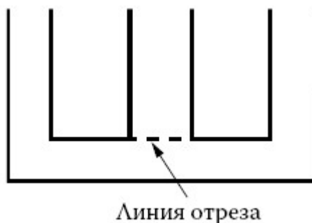
Рис. 46. Получение П-образных пластин из Ш-образных
