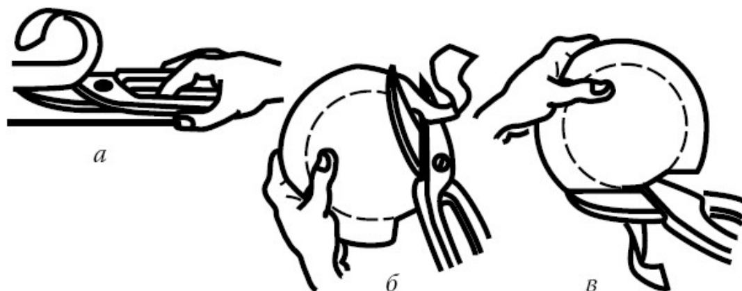
Рис. 12. Работа ножницами по металлу: а – прямолинейное разрезание; б, в – криволинейный рез
