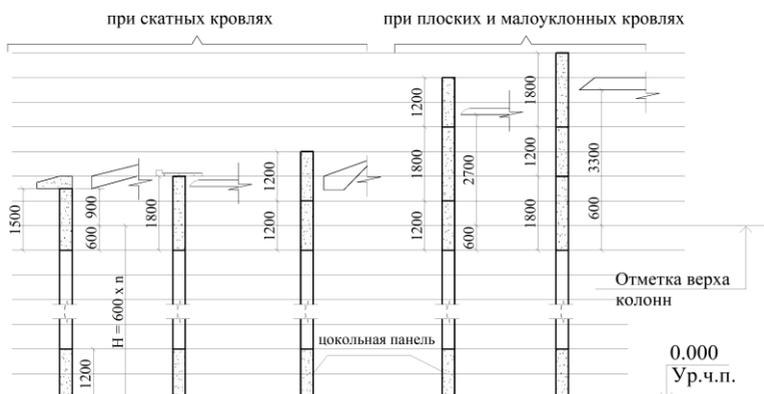
Рис. 23. Унифицированная раскладка крупноразмерных стеновых панелей в зоне опорных узлов стропильных конструкций в стенах горизонтальной разрезки
