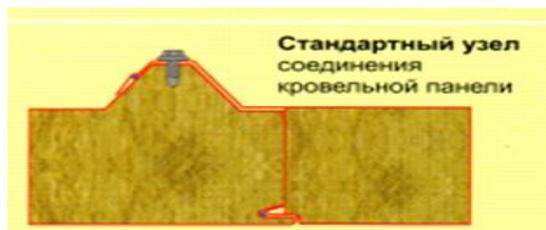
Рис. 16. Кровельные сэндвич-панели «Венталл-К». Толщина панелей составляет 50—200 мм
