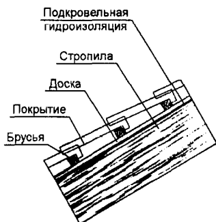
Фрагмент не утепленной скатной крыши
