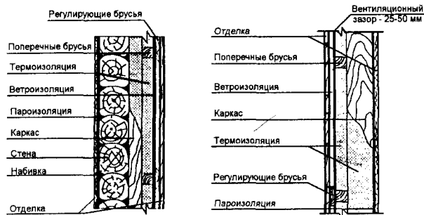
Рис. 2.20. Конструкции наружных деревянных стен
