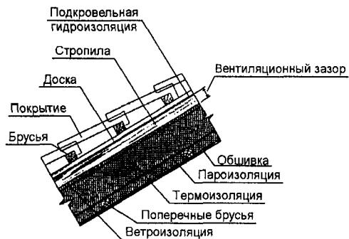
Фрагмент утепленной скатной крыши
